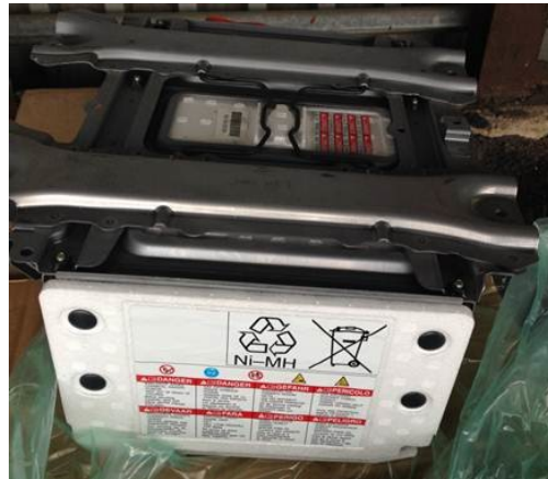
Fig. 2. NiMH-batteri från en elektrisk bil. Batteriet innehåller sällsynta jordartsmetaller.
